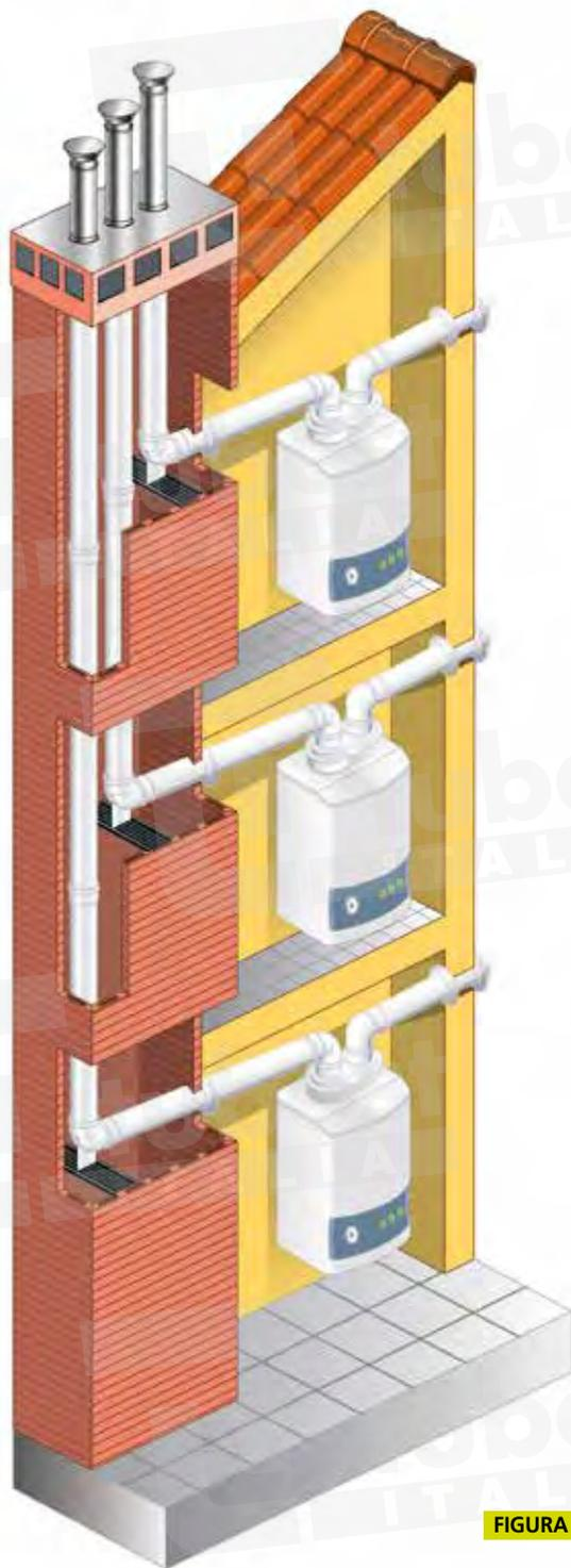
Con il sistema CONDENS può essere realizzato anche un sistema **multipo intubato (figura10)**.
