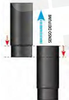
Gli elementi vanno installati inserendo la parte maschio del tubo completamente nella bicchieratura femmina, tenendo la femmina verso l'alto con il senso dei fumi indicato dalla freccia presente sull'etichetta di designazione (**figura 17**).
